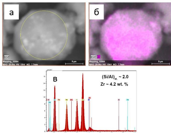
Распределение (а, б) и содержание Zr (а, в) на поверхности частицы ZrO<sub>2</sub>-анальцим
