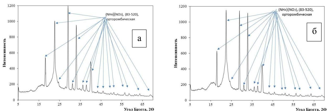
Рисунок – Дифрактограммы азотсодержащих удобрений на основе исходных опилок осины (а) и опилок после обработки 1,0 масс.% NaOH (б).
