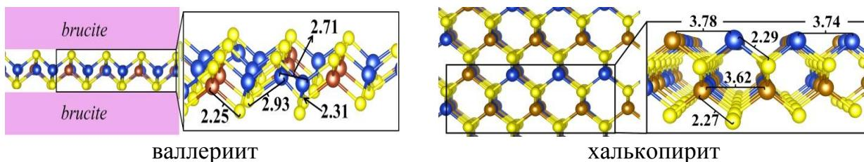
Модель структуры валлерита в сравнении с фрагментом решетки халькопирита, полученная по результатам моделирования СИ EXAFS-спектров
