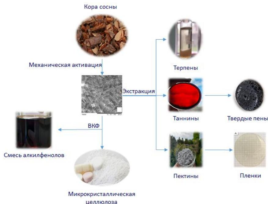
Принципиальная технологическая схема комплексной переработки коры сосны
