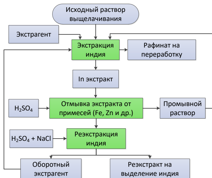
Принципиальная технологическая схема извлечения индия из сульфатных цинковых растворов
