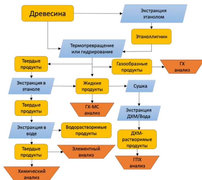
Рисунок 11 - Схема переработки древесины и лигнина, а также анализа продуктов
