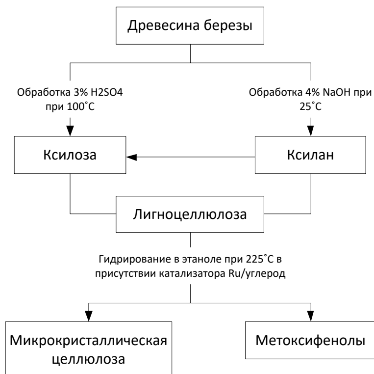
Рисунок 45 - Схема комплексной переработки древесины березы
