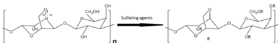
Схема сульфатирования агарозы
