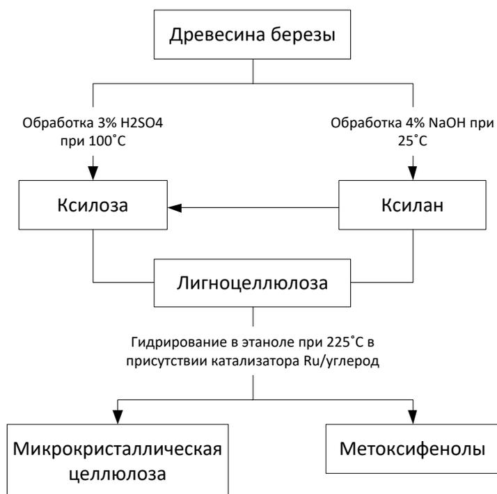
**Рисунок 9** - Схема комплексной переработки древесины березы
