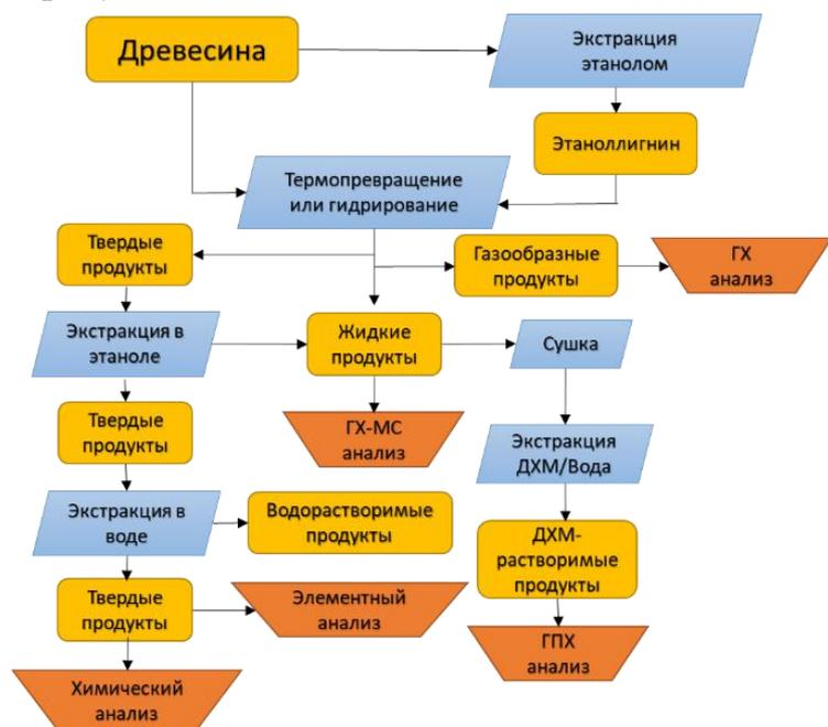
**Рисунок 1** - Схема переработки древесины и лигнина, а также анализа продуктов
