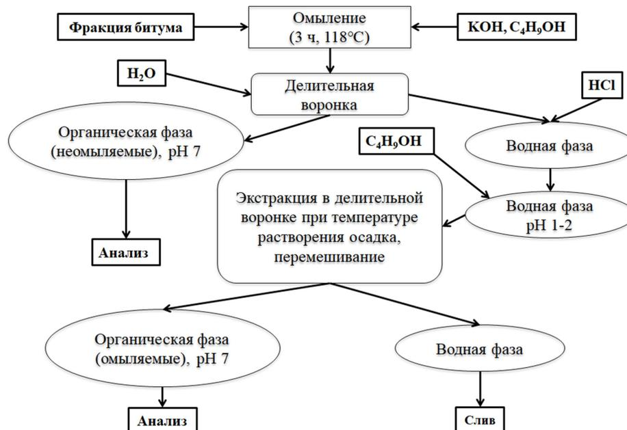
Рисунок 2.2 – Схема разделения битумов на омыляемую и неомыляемую фракцию
