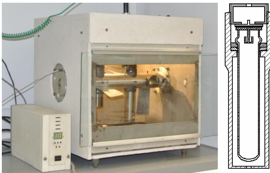
Рисунок 4 – Воздушный термостат и схема кварцевого автоклава
