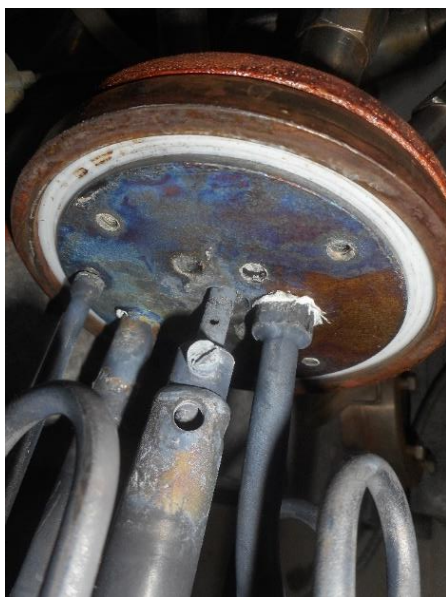
Рисунок 15а. Фотография состояния крышки титанового автоклава после проведения опыта по коррозии титана в среде 1М соляной кислоты при температуре 200°C
