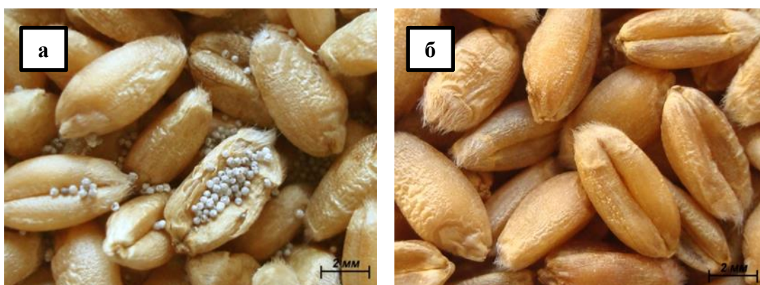
Снимки пшеницы с композитным сорбентом (а) и после ситового разделения (б)
