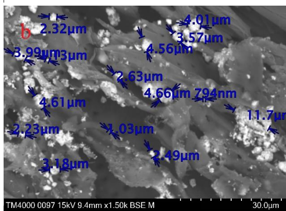
Рисунок 25. Размер и природа частиц \text{Cu}_2\text{O} (основная фаза) на поверхности костры льна. Скорость перемешивания 500 мин -1 . Увеличение: (a) 3000, (b) 1500 и (c) 1000.
