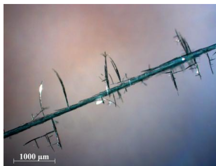
Рентгенограмма NaAlF 4 и фотография волокна NaAlF 4 , полученного конденсацией паров
